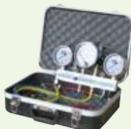
Lieferung in stoßsicherem Koffer : mit Bedienungsanleitung Prüfprotokoll des elektronischen Manometers und Wartungsanweisung.
