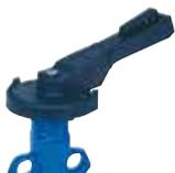
Rasterhandhebel 5 Positionen, verriegelbar, aus Verbundwerkstoff, isolierend, korrosionsbeständig.
